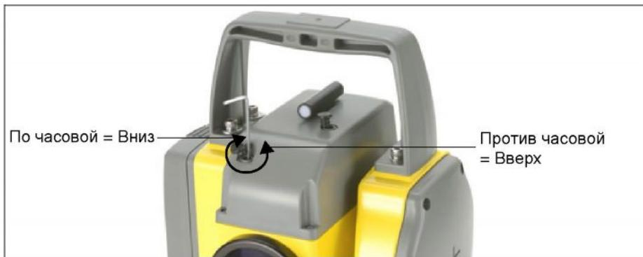
3. Для исправления горизонтального положения лазерного пятна, вставьте юстировочный ключ в порт настройки по горизонтали и поверните его как показано на рисунке. Для смещения влево по горизонтали поворачивайте юстировочный ключ по часовой стрелке. Для смещения вправо по горизонтали поворачивайте против часовой стрелки.
