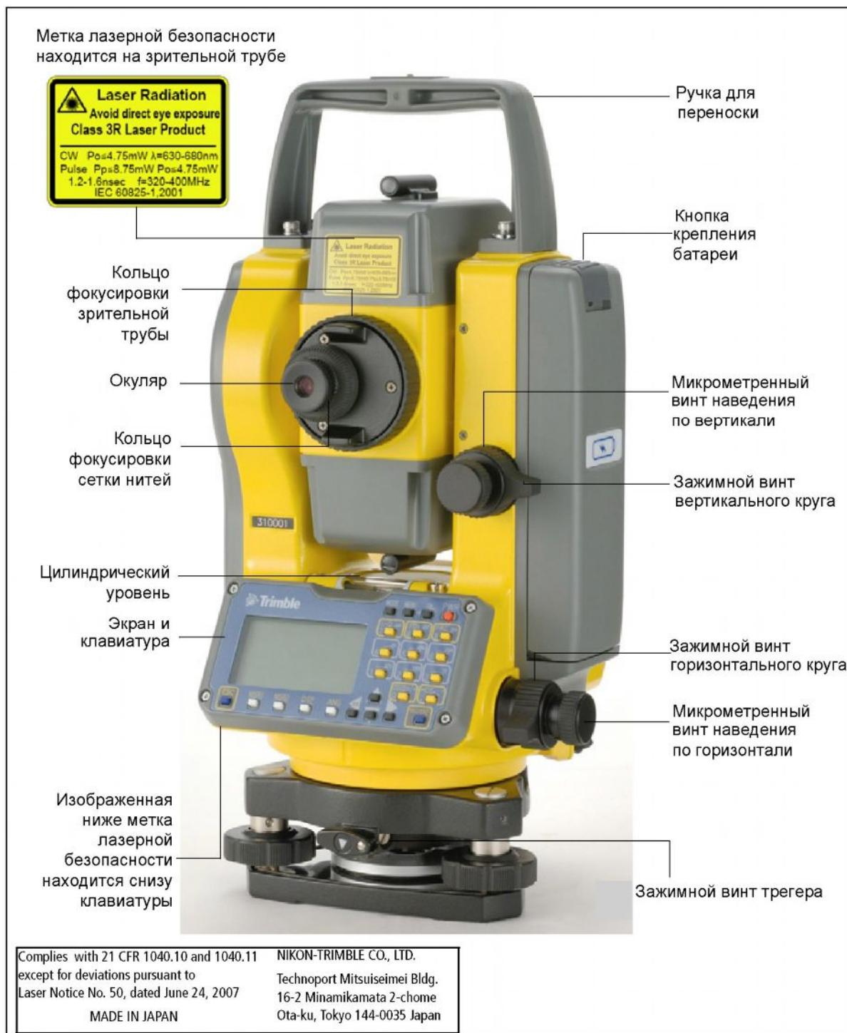
Рисунок 3.1 Обратная сторона строительного тахеометра TS525
