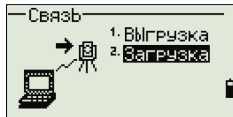
Используйте кабель RS-232C для соединения TS525 с компьютером. В программе загрузки установите контроль потока данных Xon/Xoff.
