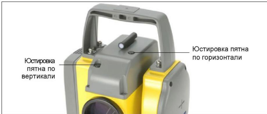
2. Для исправления вертикального положения лазерного пятна, вставьте юстировочный ключ в порт настройки по вертикали и поверните его как показано на рисунке. Для смещения вниз по вертикали поворачивайте юстировочный ключ по часовой стрелке. Для смещения вверх по вертикали поворачивайте против часовой стрелки.
