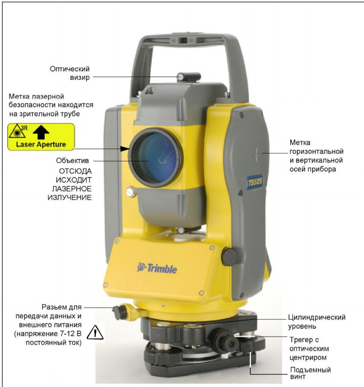
Рисунок 3.2 Передняя сторона строительного тахеометра TS525
