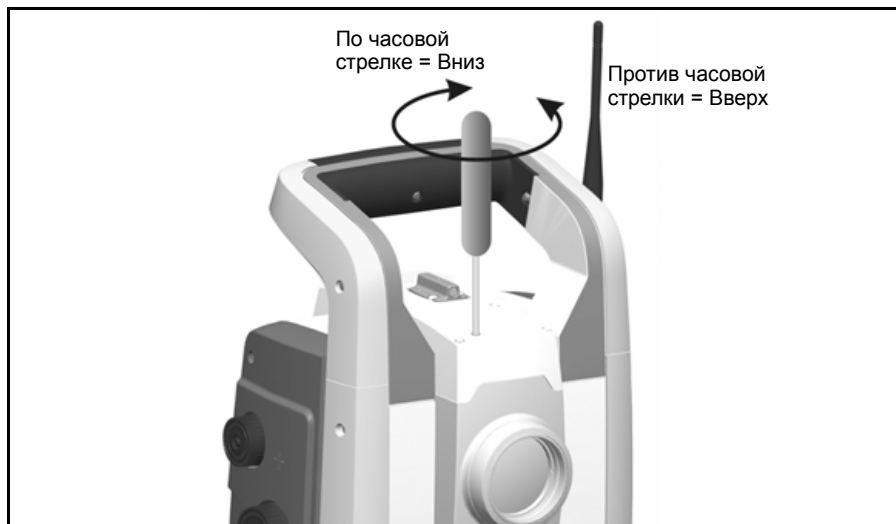
Рис. 4.34. Юстировка вертикального положения
