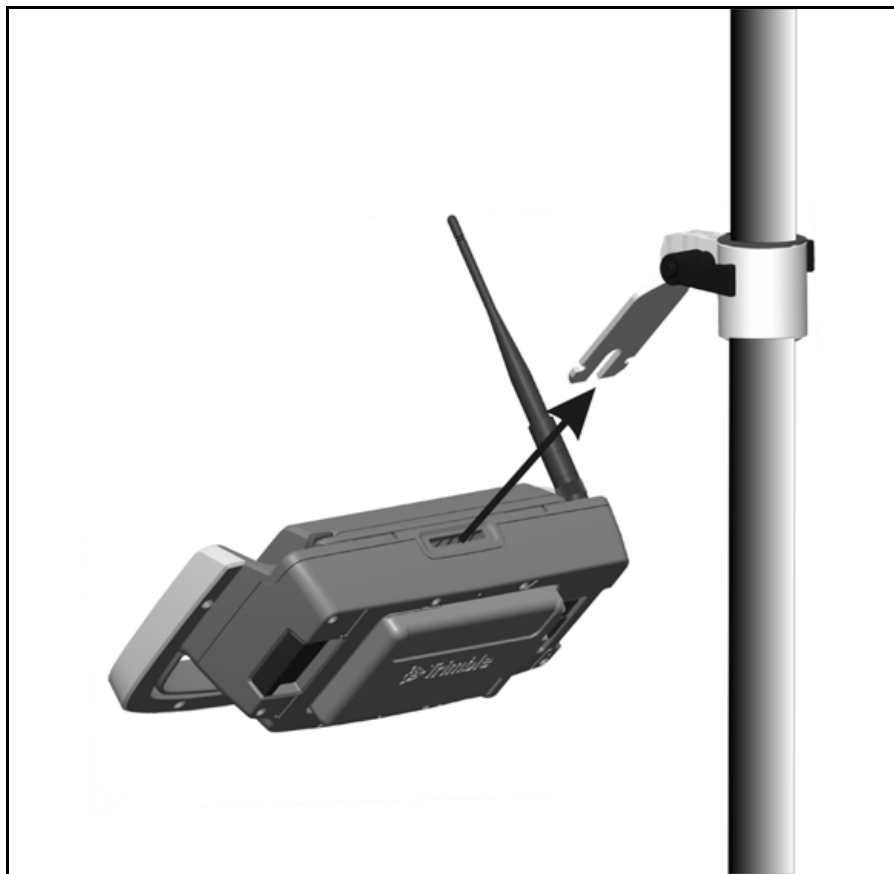
Рис. 7.75. Установка держателя Trimble Robotic на адаптер стандартной вежи
