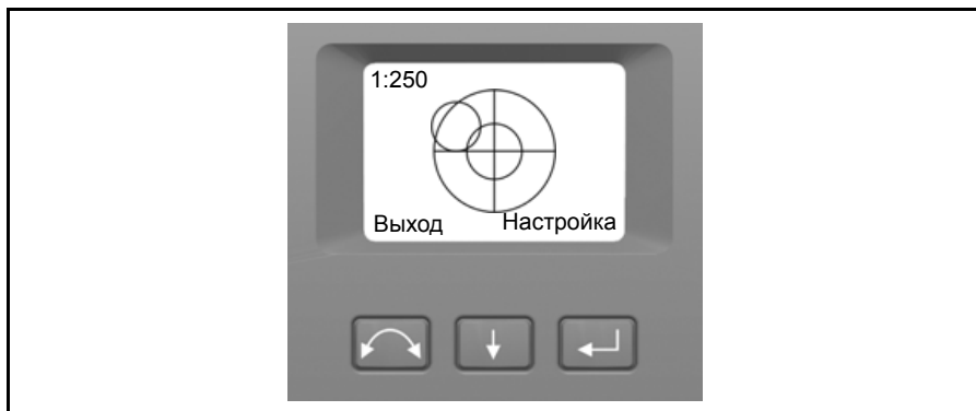
Рис. 3.18. Окно электронного горизонтирования на дисплее круга 2
