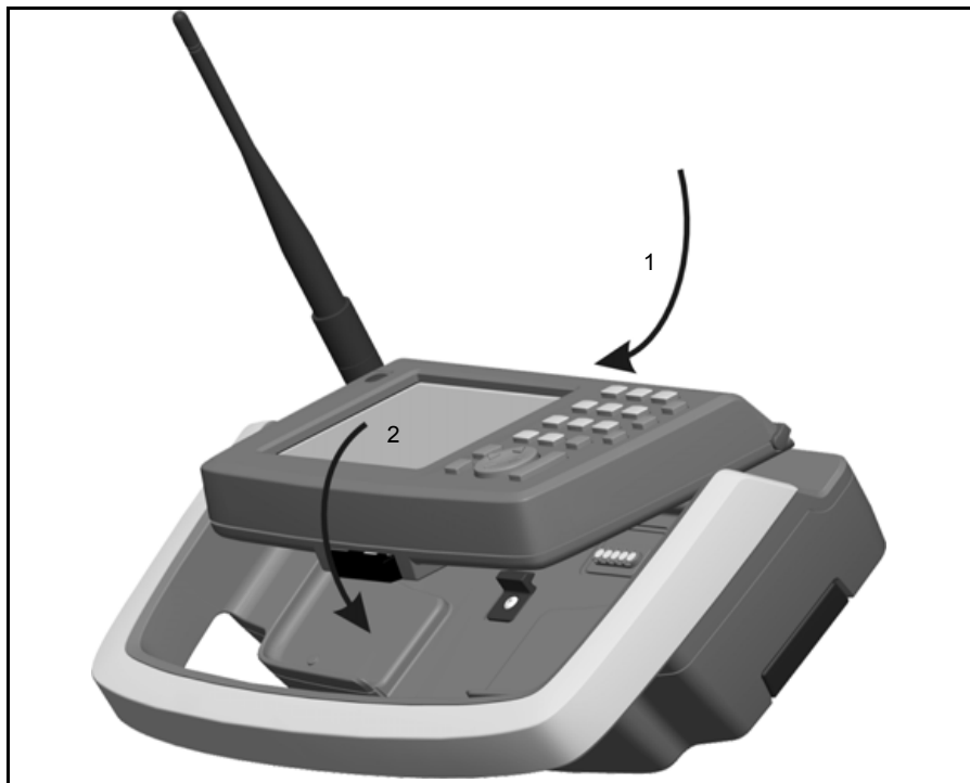
Рис. 7.73. Подсоединение контроллера Trimble CU к держателю Trimble Robotic
