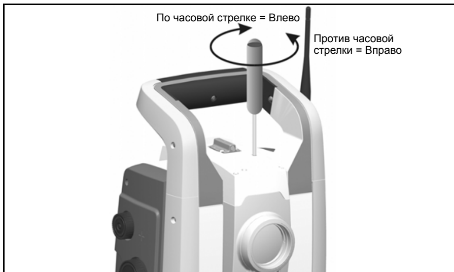
Рис. 4.35. Юстировка горизонтального положения
