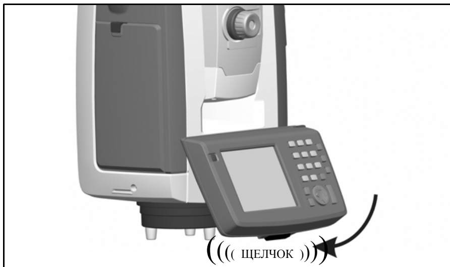
Рис. 4.40. Установка контроллера Trimble CU
