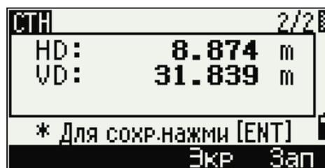
Если вы определили линию путем ввода координат T2, отобразится разность HD (dHD) и VD (dZ) между измеренными вами данными и введенными координатами.
