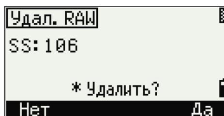
Система тахеометра также удаляет соответствующие координаты точки, когда вы удаляете ее как SS или CO запись.
