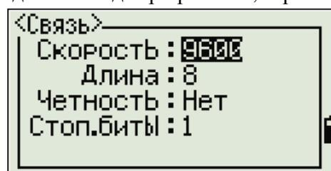
Используйте кабель RS-232C для соединения TS515 с компьютером. В программе загрузки установите контроль потока данных Xon/Xoff.
