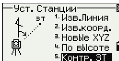
Поле АЗ относится к текущей прочтенной величине АЗ, а поле ЗТ к задней точке при последней установке станции.
