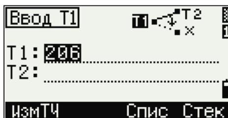
Введите положительный или отрицательный угол, горизонтальное проложение и вертикальное расстояние от базовой линии, определенной по точкам T1–T2.
