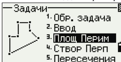
Счетчик в правом верхнем углу экрана показывает, сколько точек вы ввели. Для последовательного ввода номеров точки используйте программную клавишу От/До.
