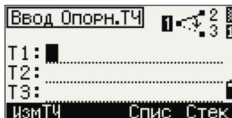
3. Введите вторую точку (Т2) для определения базовой линии, Т1–Т2. Угол (dГК) измеряется от базовой линии.
