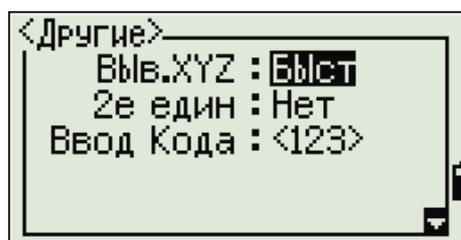
Поле Вывод XYZ определяет скорость перехода к следующему экрану после отображения XYZ координат вводимой точки.
